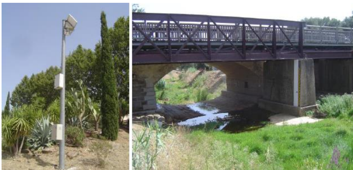
Figure 5-1: Mise en place récente d'une caméra de surveillance des niveaux d'eau au droit du pont de la cave coopérative
